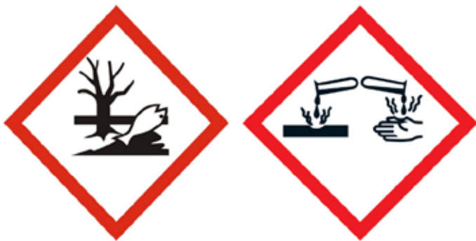
Figure 1 Exemple de pictogrammes : produit dangereux pour l'environnement et produit corrosif.
